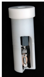
Abb. links: Prototyp entriegelt und hohe Feuchtigkeit; Der Feuchteindikator ist in den frischen Estrich eingebaut, Indikator auf zweiter Stufe, sichtbar (Pfeil)
