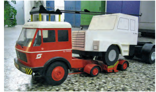
Modell: Lastzüge (an Oberleitungen) ziehen Lkw über den Brenner.
