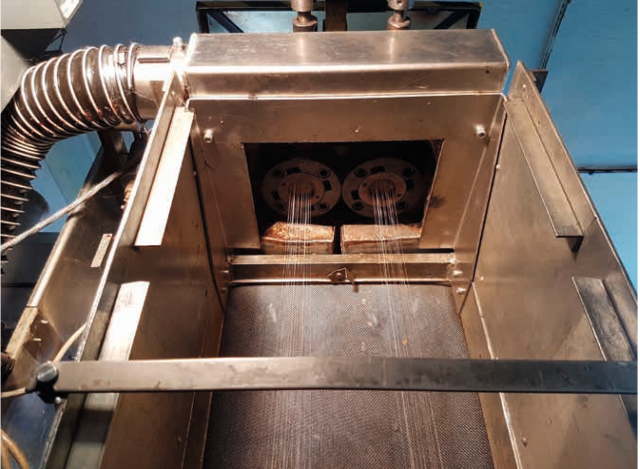
Spinnanlage beim Spinnen von Recycling-PET aus Leintüchern.
